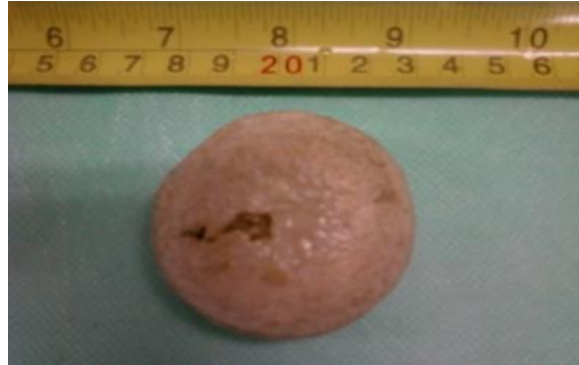
(D) Step 2 : P.E=0.5J, PRR=20Hz, p=20 weight=66.45 gram weight loss=0.28 gram
