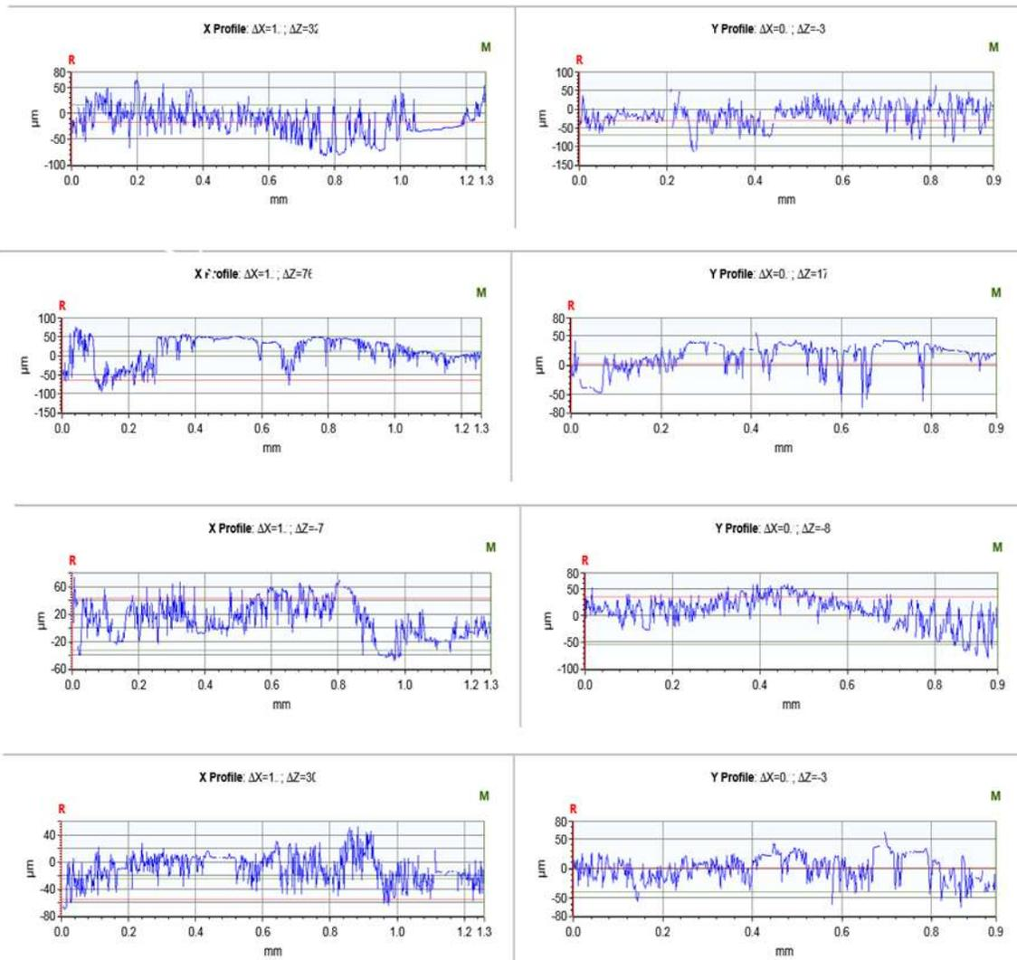
Fig.6: .Profilometry of the surfaces of the samples:(a) $v=700\text{mm/s}$   $h=0.06\ \mu\text{m}$  ,(b)  $v=700\text{mm/s}$   $h=0.08\ \mu\text{m}$  ,(c)  $v=800\text{mm/s}$   $h=0.06\ \mu\text{m}$  (d)  $v=800\text{mm/s}$   $h=0.08\ \mu\text{m}$  ,(e)  $v=900\text{mm/s}$   $h=0.06\ \mu\text{m}$  ,(f)  $v=900\text{mm/s}$   $h=0.08\ \mu\text{m}$  ,(g)  $v=1000\text{mm/s}$   $h=0.06\ \mu\text{m}$  ,and(h)  $v=1000\text{mm/s}$   $h=0.08\ \mu\text{m}$  .
